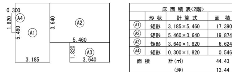
2階 床面積求積図 S:1/200
