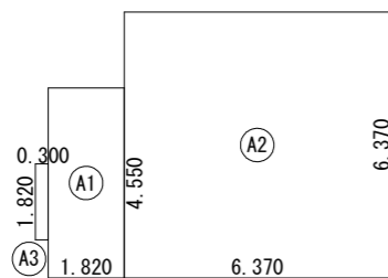
1階 床面積求積図 S:1/200
